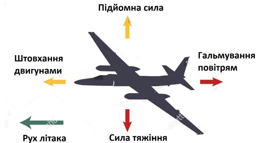
Мал. 15.12. Зліт літака можливий, якщо підйомна сила більша, ніж сила тяжіння до Землі
