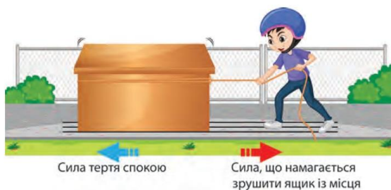
Мал. 37.2. Сила тертя спокою й зовнішня сила спрямовані протилежно
