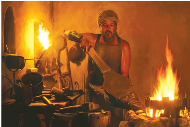
Мал. 38.4. Міхи для нагнітання повітря в полум'я для підвищення його температури
