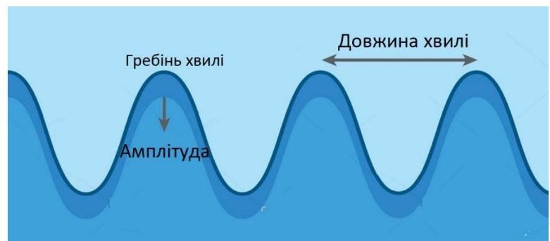
Мал. 6.1. Хвиля — це коливання частинок речовини навколо певного рівноважного положення. При цьому частинки не переміщуються разом із хвилею, хвилі переносять енергію, а не речовину
