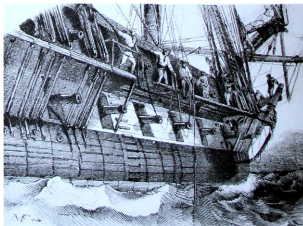
Мал. 10.7. Моряки лотом вимірюють глибину. Як тільки гиря сягає дна, моряки замірюють довжину мотузки, що й дорівнює глибині в даному місці
