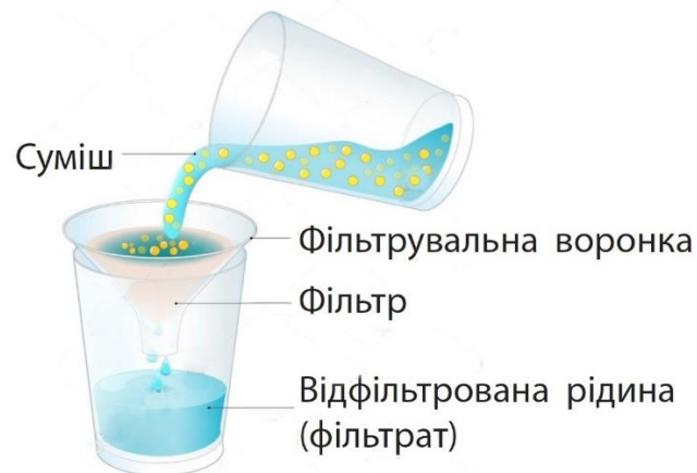
Мал. 2.5. Фільтрування. Вода та розчинені речовини проходять крізь фільтр, а великі часточки — ні
