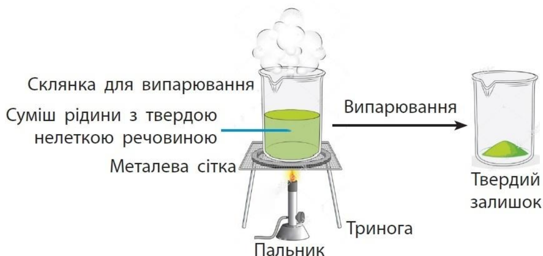
Мал. 2.7. Випарюванням можна відокремити нелетку речовину з розчину
