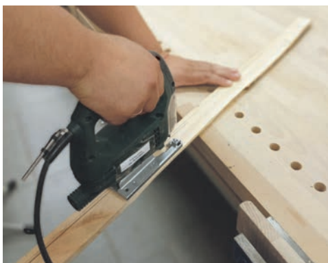
Мал. 4.5. Виготовлення деталей способом випилювання за допомогою різних інструментів
