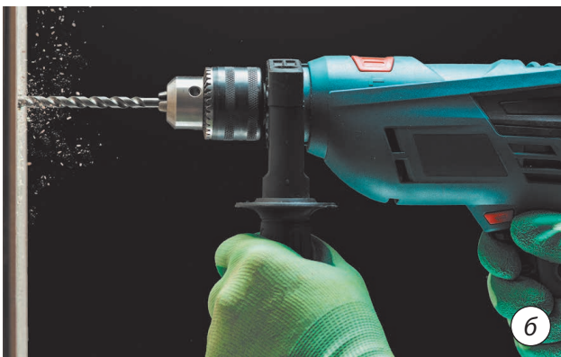
Мал. 9.12. Положення дреля під час свердління
