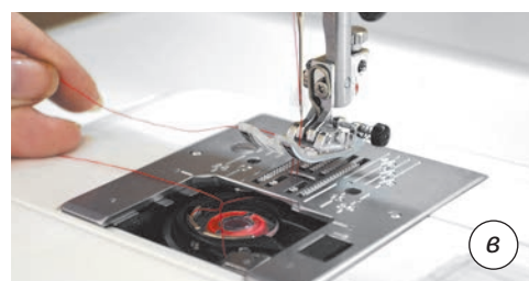
Мал. 10.23. Заправлення нижньої нитки в машину з горизонтальним човниковим механізмом
