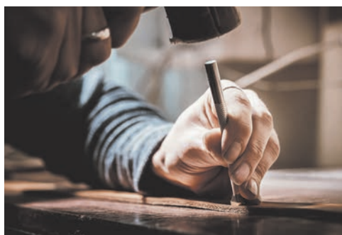
Мал. 9.19. Користуючись отриманою міткою, розширюють отвори
