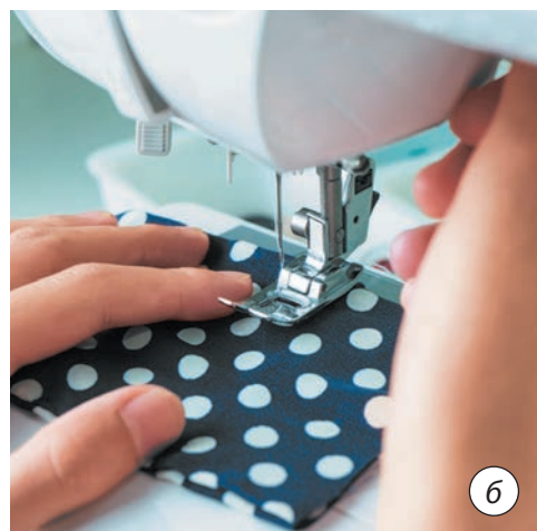
Мал. 8.6. Процес зшивання деталей: а — вручну; б — на швейній машині
