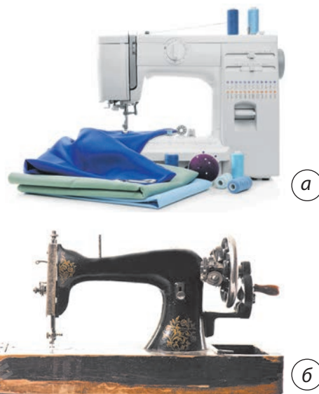
Мал. 4.2. Приводні механізми швейної машини: а — швейна машина з електричним приводом; б — швейна машина з ручним приводом
