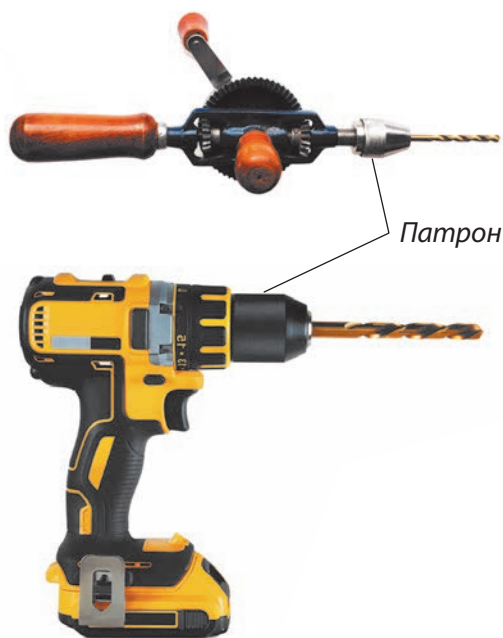
Мал. 9.10. Закріплення свердла в патроні
