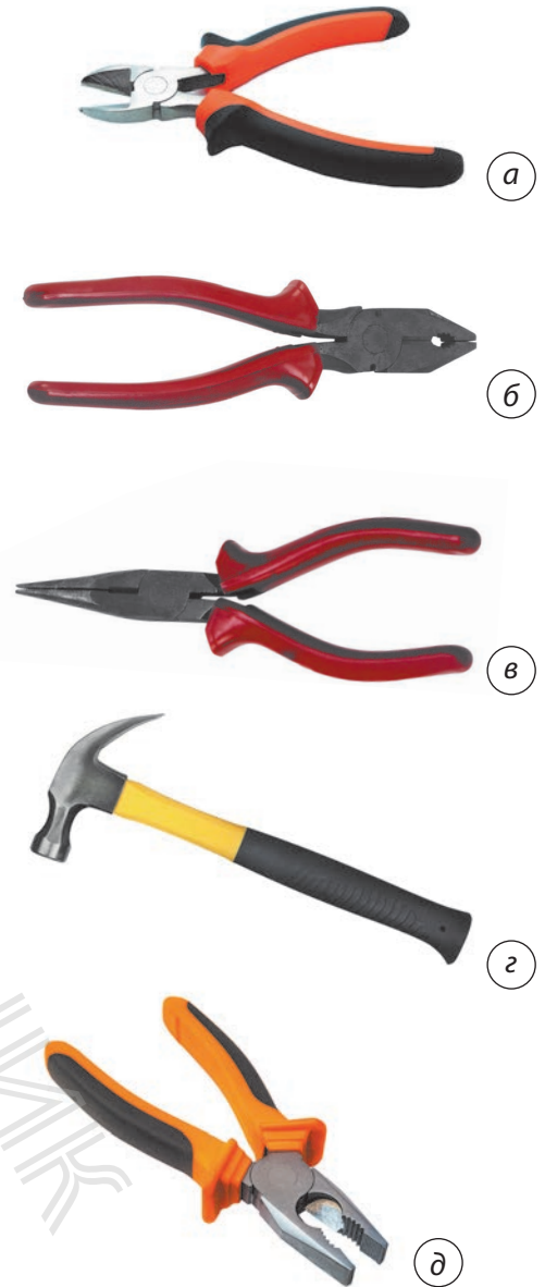
Мал. 12.2. Інструменти для роботи з дротом: а — кусачки; б — пасатижі; в — круглогубці; г — молоток; д — плоскогубці
