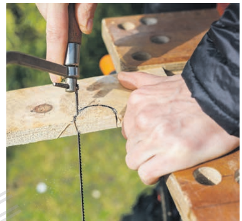
Мал. 9.8. Випилювання по зовнішньому контуру
