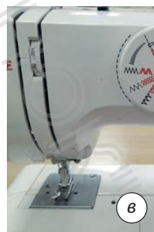
Мал. 10.20. Швейні машини з різними приводами: а — ручним; б — ножним; в — електричним
